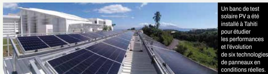
Un banc de test solaire PV a été installé à Tahiti pour étudier les performances et l'évolution de six technologies de panneaux en conditions réelles.
